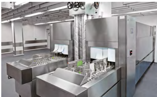
Abb. 4-10: Käfigbandreinigungsanlage mit verschiedenen Zonen
