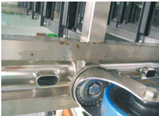
Abb. 9-7 Ansicht Edelstahlgestelle mit Korrosion
