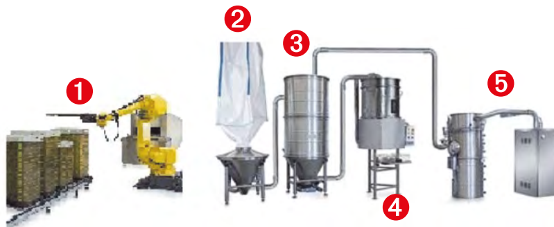
Abb. 4-19 Beispiel eines vollautomatischen Systems: Befüllung der Käfige mit Roboter oder Automaten ①, Befülltrichter saubere Einstreu z. B. mit BIG-Bag ②, optionales Lagersilo ③, Dosierspeicher mit Staubabsaugung ④ und Vakuumerzeuger und Staubfilter ⑤ für die pneumatische Förderung.
