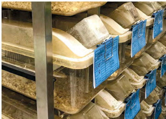
Abb. 9-2 links Käfighaube und Tränkeflasche aus Polysulfon mit milchig weiß aussehender Materialeintrübung, rechts Detailansicht Käfighaube
