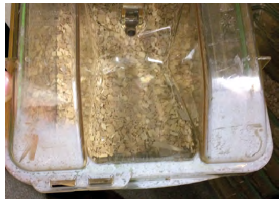
Abb. 9-2 links Käfighaube und Tränkeflasche aus Polysulfon mit milchig weiß aussehender Materialeintrübung, rechts Detailansicht Käfighaube
