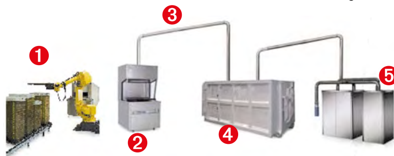
Abb. 4-7 Beispiel eines vollautomatischen Systems: Entleerung der Käfige durch Roboter oder Automaten ① in den Abwurftrichter ②, mit pneumatischer Förderung über Rohrleitung ③ in externes Behältnis ④; Vakuumerzeuger und Staubfilter ⑤
