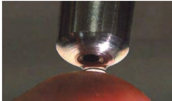
Abb. 9-8 Darstellung Tränkenippel mit Tropfen (Fingertest zum Abziehen eines Tropfens)
