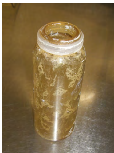
Abb. 7-7 Tränkeflasche mit Prüfanschmutzung
